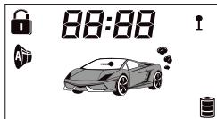
Для отключения режима охраны с заведенным двигателем нажмите кн. , двери откроются, режим охраны будет отключен. Индикация LCD дисплея:
