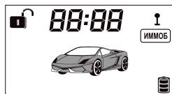
Для отключения иммобилайзера нажмите кн. , блокировка двигателя отключится, светодиод погаснет.
