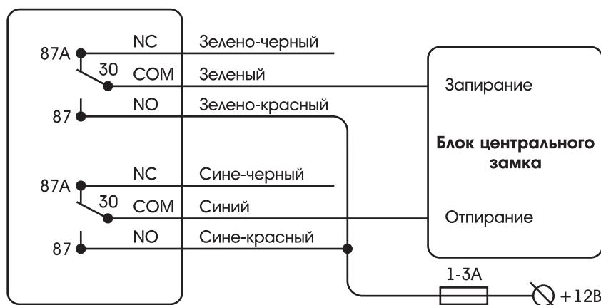
Подключение к штатному блоку с управлением отрицательными импульсами 0.8 с
