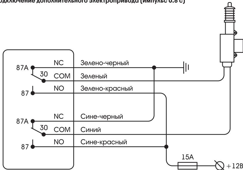
**Подключение к штатному блоку с управлением положительными импульсами 0.8 с**
